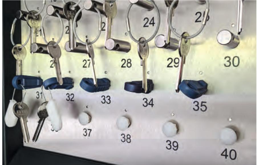
Posiciones con bloqueo ( clavijas plateadas), posiciones sin bloqueo (clavijas azules), posiciones desactivadas ( tapones blancos).
